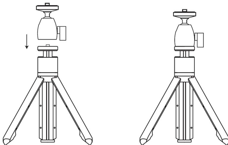
Прокрутите штатив с резьбой 1/4 дюйма и поворотный адаптер к разъему с резьбой 1/4 дюйма на нижней части EMEET StreamCam One.
